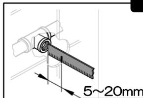
配管は取付穴中心に設置し、
