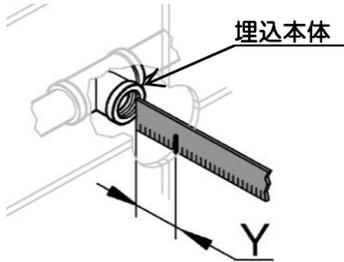
2. ニップルのねじ部側を、上記1で測定した寸法に38mm加えた寸法分を残し切除します。
