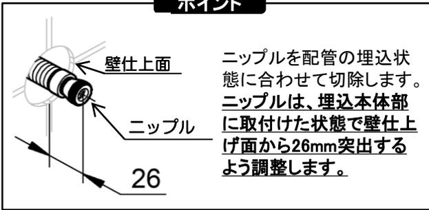
1. 壁仕上げ面から埋込本体の距離を測定します。
