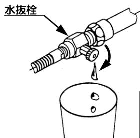
ツマミを回すと水抜き栓から水栓内に残った水を出すことができます
