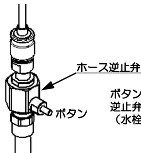
ボタンを押すと逆止弁が開放されます。(水栓内の水を抜けるようになります)
