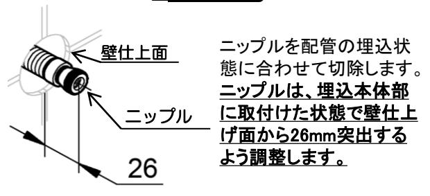
ニップルを配管の埋込状態に合わせて切除します。
